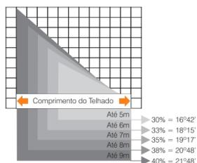
A inclinação mínima do telhado deve ser de 30% para telhas Coppo Veneto e Double S e 50% para telha Plana em um comprimento conforme tabela acima. Para comprimentos maiores, acrescentar 2 graus para cada metro. Acima de 90 graus de inclinação é necessário amarração.
